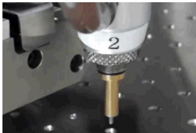
Les vis sont présentées une à une dans un espace parfaitement plat et dégagé où sans aucune gêne elles sont prises au bout du canon d'aspiration.
