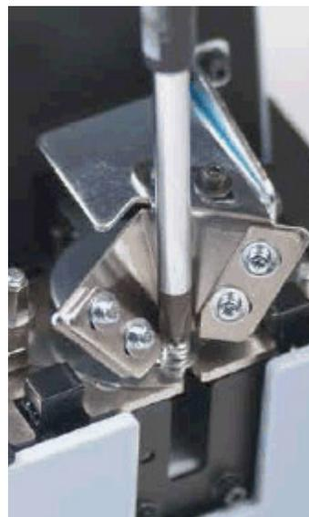
Les vis sont présentées une à une au fond d'un guide lame en forme d'entonnoir où sans aucun effort de précision elles se fixent à l'embout de vissage magnétique.
